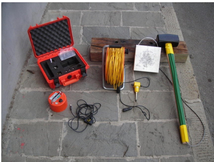
Figura A. 3b - Versione “GEMINI MASW” impiegata per la prospezione sismica attiva: lo stendimento prevede il collegamento della strumentazione procedendo da sinistra verso destra. In aggiunta va inserito il PC come per una normale acquisizione HVSR.
